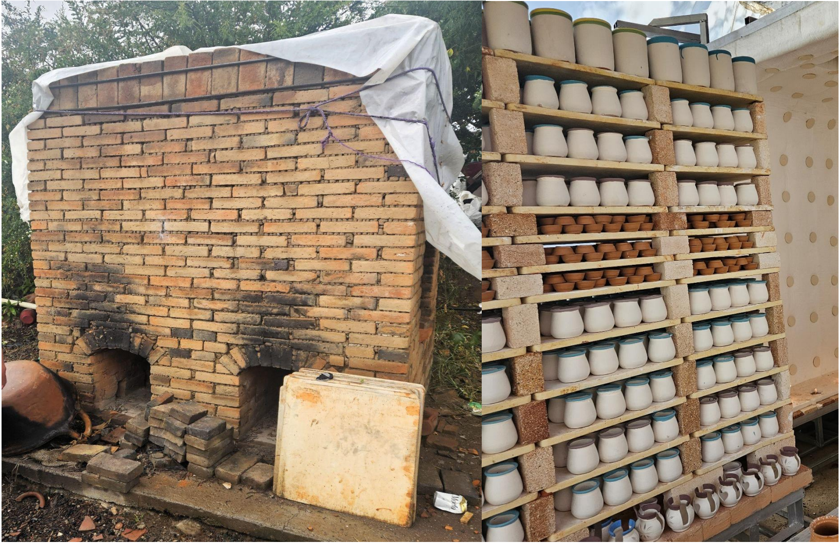
Figura 13. Horno de leña mejorado hecho por el programa Barro Aprobado mayormente financiado por la empresa Clarios a través de su fundación Pure Earth (Pure Earth México, 2020). Fuente: elaboración propia.
