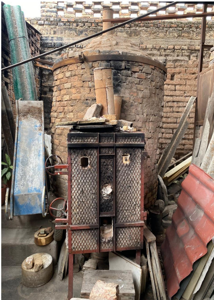
Figura 18. Horno de leña para alfarería libre de plomo, Jalisco. Fuente: elaboración propia.
